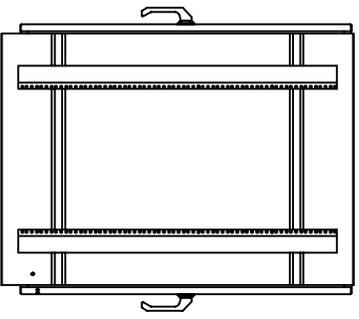
LEFT SIDE VIEW WITH INTERNAL RACK RAILS SHOWN
